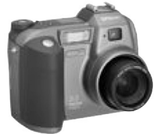
Cámara digital (2001). ▶ A finales del siglo pasado comenzó a extenderse la fotografía digital, que permite tomar fotografías sin película (las fotos se almacenan en una memoria interna regrabable) fácilmente distribuibles por Internet, pero con menos calidad que en la fotografía de 35 mm.
